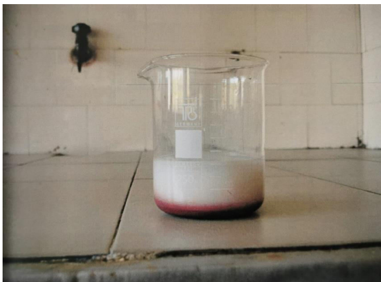
Εικόνα 5.4. Μελέτη της σταθερότητας των συνθετικών χρωστικών οξειδίου του σιδήρου, από το αρχείο της διπλωματικής εργασίας μου στην τεχνητή γήρανση χρωμάτων, 2008.
