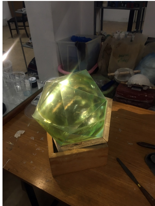
Εικόνα 24 Χύτευση εποξικής ρητίνης σε διπλό καλούπι (καλούπι εσωρετικό και εξωτερικό), 2022
