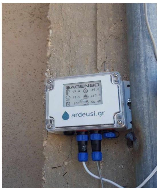
Εικόνα 8.32 Ο Περιβαλλοντικός - Μετεωρολογικός σταθμός στο εργοτάξιο του Δήμου Ασπροπύργου. Φωτογραφικό αρχείο της καλλιτεχνικής πλατφόρμας Συν+Εργασία
